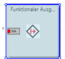
Abbildung 157 Funktionsblock "Funktionaler Ausgang/Melde Datei", Ansicht im Funktionsplan
