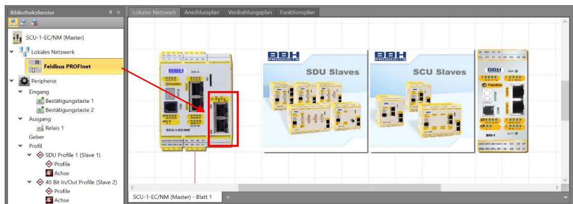
Abbildung 147 Konfiguration der Feldbuschnittstelle im Mastergerät
