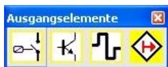
Die Ausgangselemente schaffen die digitale Verbindung zwischen einem oder mehreren angeschlossenen externen Schaltkreisen mit dem **SMX100 System**. Jedes Ausgangselement wird über den Funktionsplan mit einem logischen Eingangssignal „0“ oder „1“ angesteuert.
