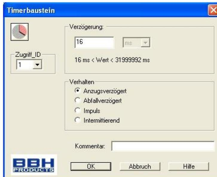
**Block ID:** Nummer des Timers. Diese kann beim Einfügen eingestellt werden. Sind alle Timer verbraucht, so wird der Timer Befehl im Menü gesperrt.
