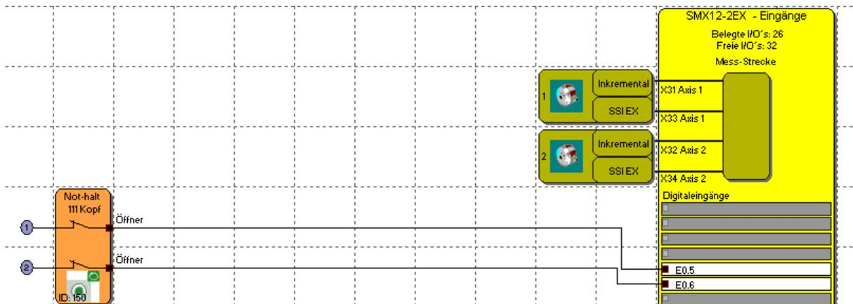
Not-Aus Kontakte vom Not-Ausrelais mit Pulsen von der SMX100
